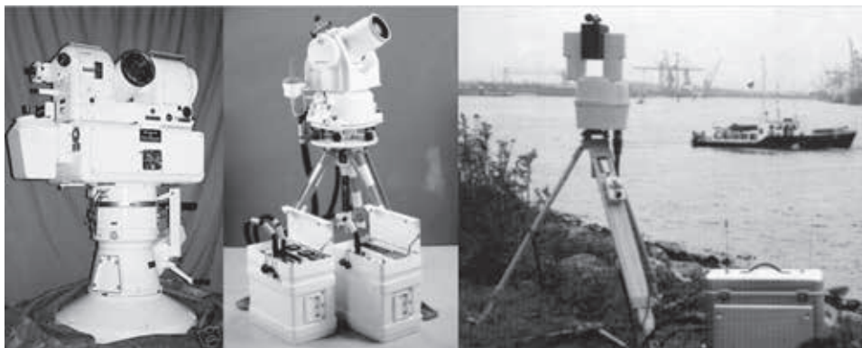
Slika 5. Contraves EOTS kineteodolit (lijevo) [23], AGA-Minilir kineteodolit (sredina) [24], i Krupp Atlas Polarfix (desno) [22].
