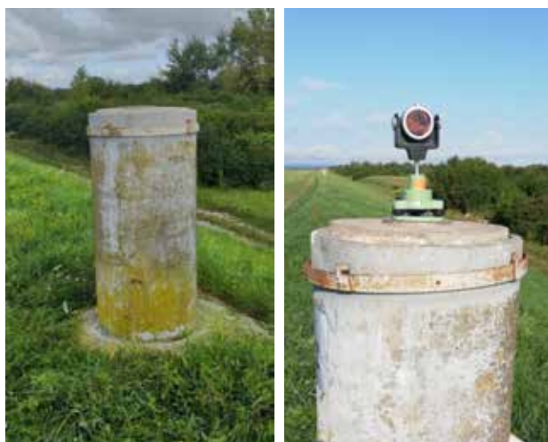
Slika 4. Stabilizacija (lijevo) i signalizacija (desno) na stupovima kalibracijske baze.
