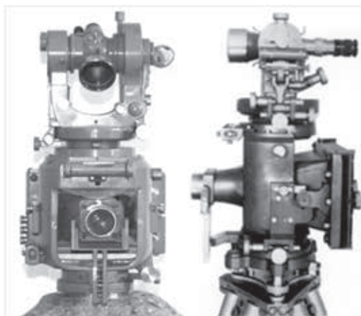
Slika 3. Wildovi fototeodoliti P30 (lijevo) i FT9 (desno) [20].
